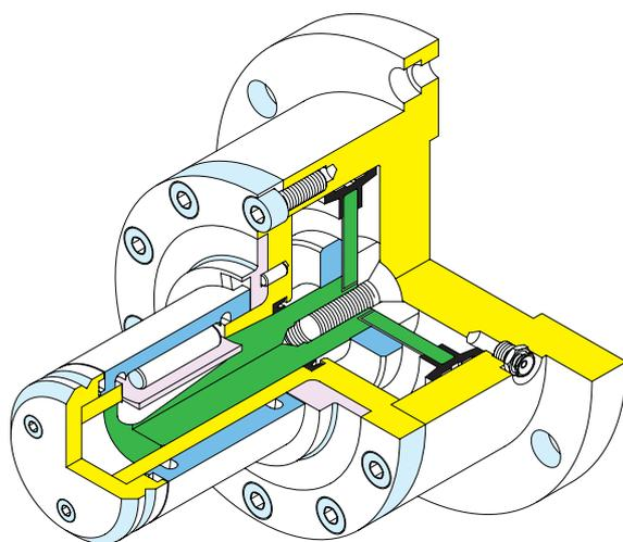
La testata 714/MZ-A è indicata sia per lo svolgimento che per l'avvolgimento dove sia necessaria una perfetta centratura della bobina. Consente portate elevate ed un'alta velocità di lavoro, abbinate ad un momento torcente molto elevato, soprattutto su anime di acciaio: il corpo testata e gli elementi espansibili (tegoli), sono in acciaio. L'attacco in macchina è sempre eseguito su disegno del cliente.
