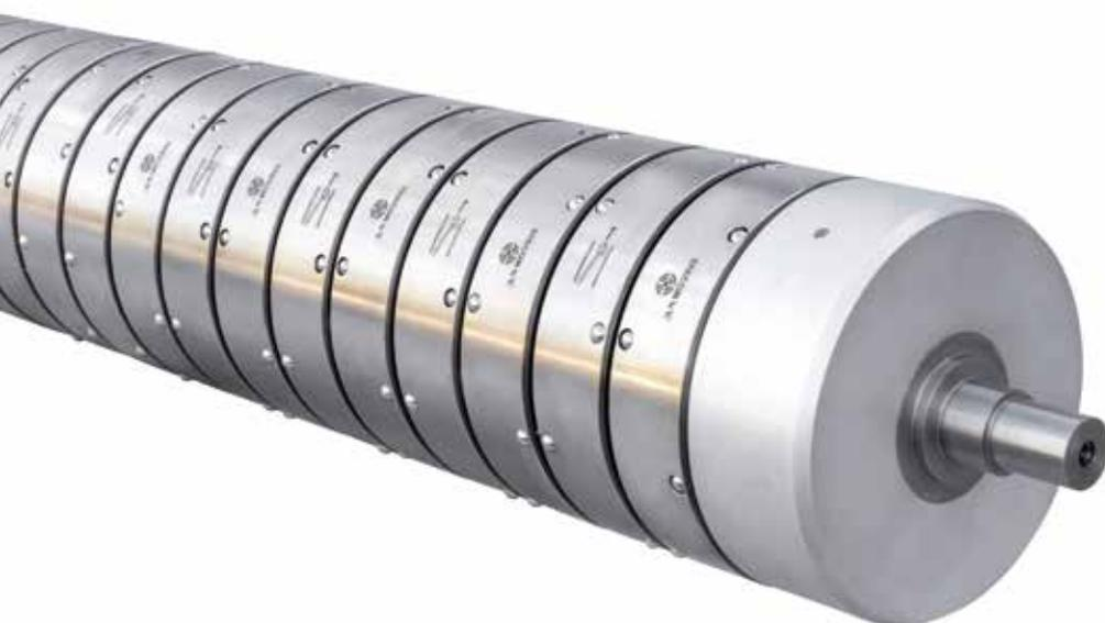
**Die Differenzialwelle mit Kugeln Modell 650/PLS besteht aus einer Reihe von selbstexpandierenden Ringen, die unabhängig voneinander mehrere Rollen unterschiedlicher Breite aufwickeln können, wodurch Spannungsunterschiede beim Aufwickeln vermieden werden.**
